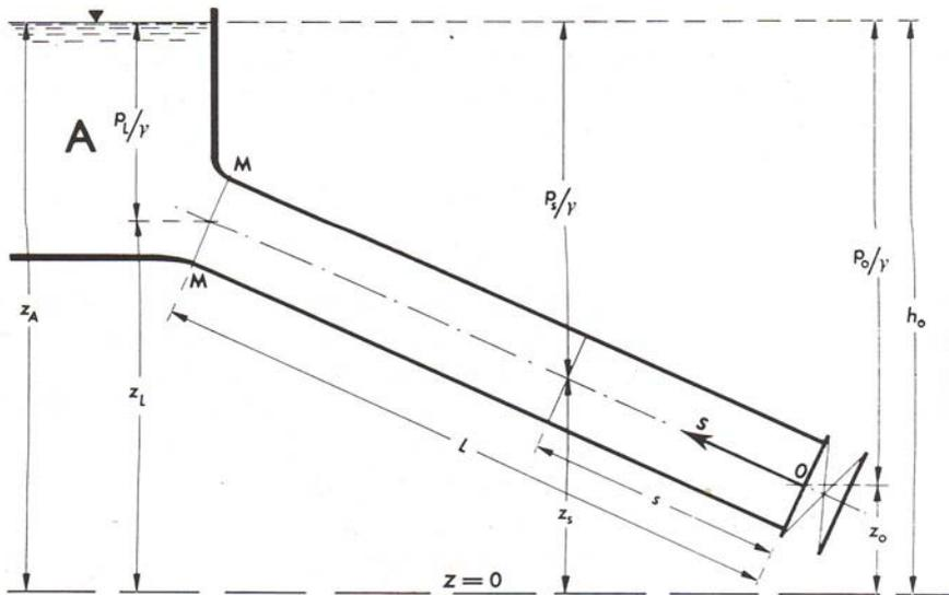
Una chiusura brusca dell'otturatore che azzeri la velocità genera una sovrappressione  $\Delta p$  che viaggerà sotto forma di onda verso l'imbocco della condotta. Ad un certo istante  $dt$  (contato a partire dalla chiusura) l'onda avrà coperto
