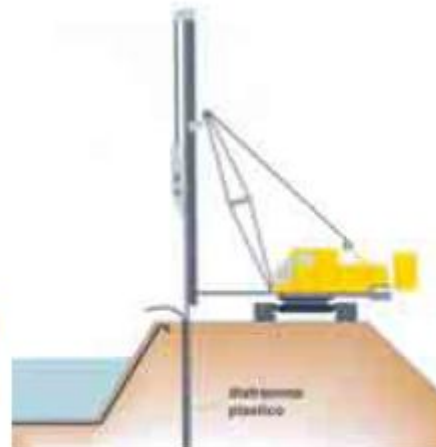
Figura 2.1.4: Quando necessario, soprattutto nel caso di argini esistenti, si può assicurare l'impermeabilità del rilevato arginale mediante geosintetici usati sia in superficie che all'interno dell'argine stesso come un diaframma verticale.
